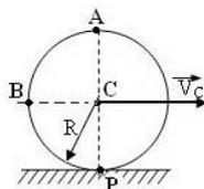
17. Диск радиуса  $R=10$  см вращается вокруг оси  $Ox$  по закону  $\varphi = 4+5t$  с<sup>-1</sup>.
