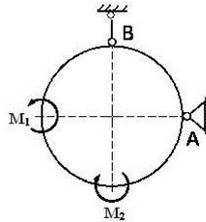
19. Невесомая изогнутая балка ACB находится под действием двух пар сил, моменты которых соответственно равны  $M_1 = 3$  нм,  $M_2 = 12$  нм  $AC = 3$  м,  $BC = 4$  м. Указать модуль реакции опоры B.
