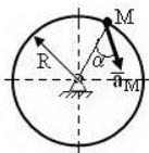
20. Ускорение точки **M** диска, вращающегося вокруг неподвижной оси  $a_M = 4$  м/с<sup>2</sup>. Определить угловую скорость  $\omega$  этого диска, если  $R = 0.25$  м и угол  $\alpha = 60^\circ$ .
