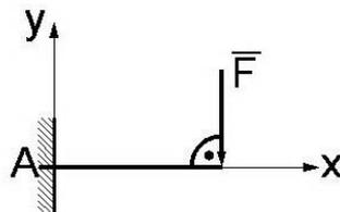
16. . Указать все ненулевые реакции невесомой консольной балки, на которую действует сила  $\bar{F}$  ( $X, Y$  - реакции вдоль осей  $x, y$  соответственно,  $M$  - момент заделки).
